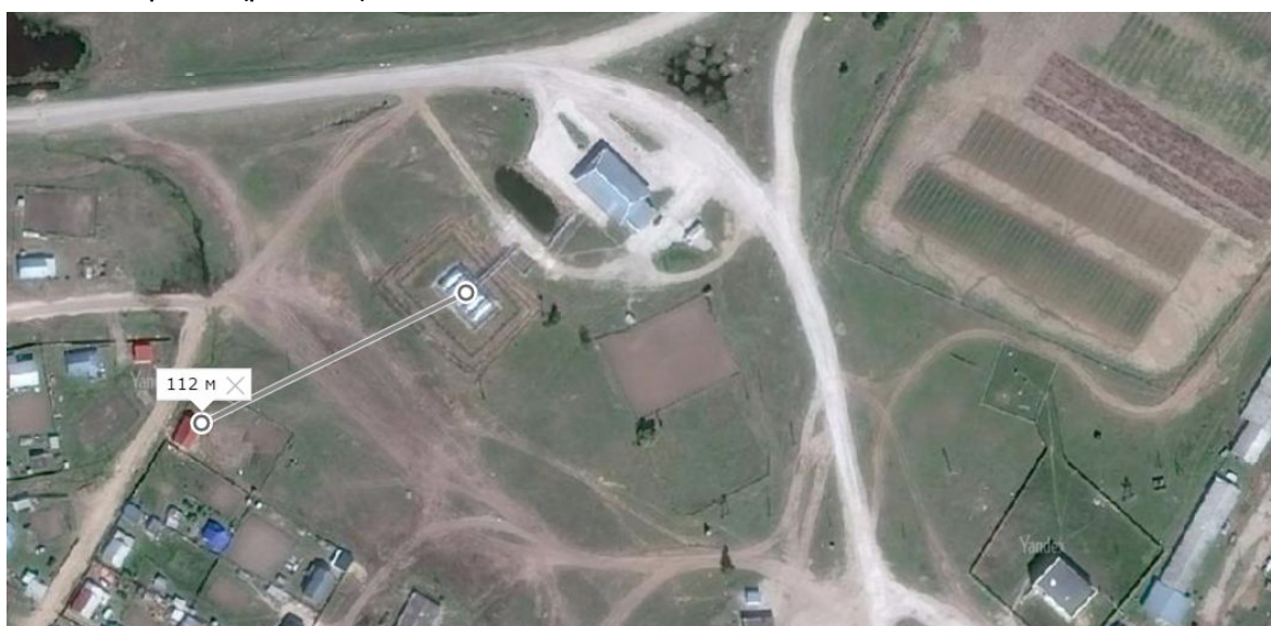
Рис. 14. Расстояние от центра паровоздушного облака до жилого дома
